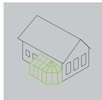
Односкатная крыша с многоугольником с одной стороны
