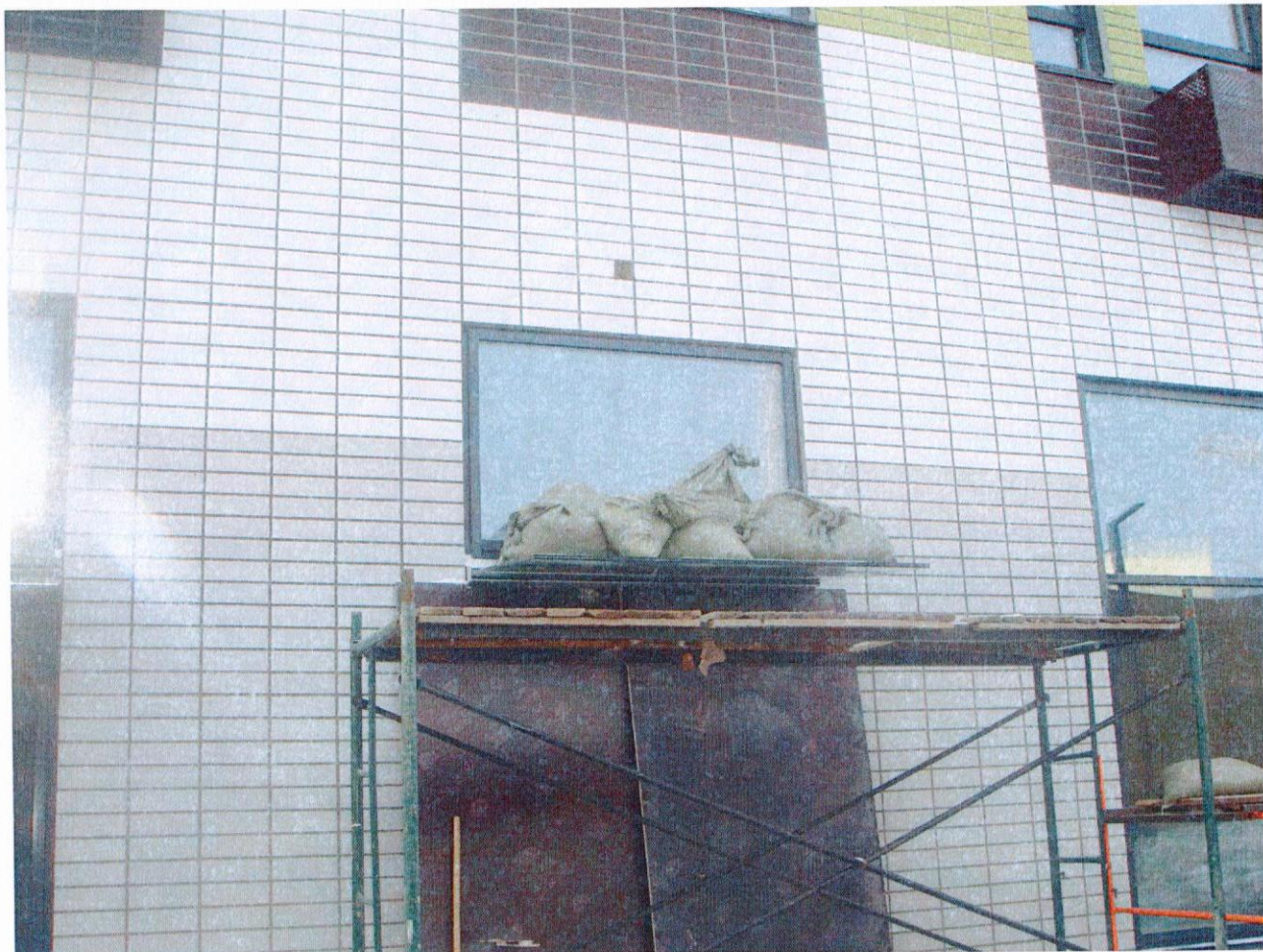
Рис. 2. Фото козырька с приложением полной расчетной нагрузки
