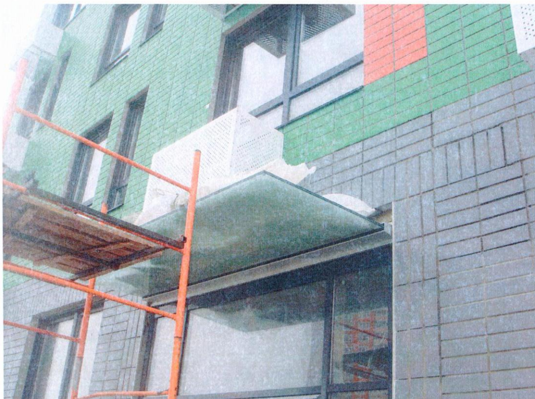
Рис. 2. Фото козырька с приложением полной расчетной нагрузки
